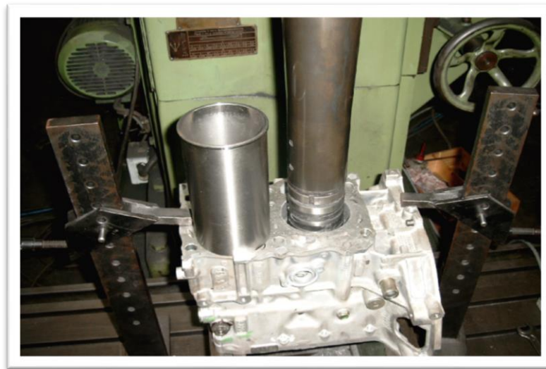
Figuur 17: uitboren van de cilinder
