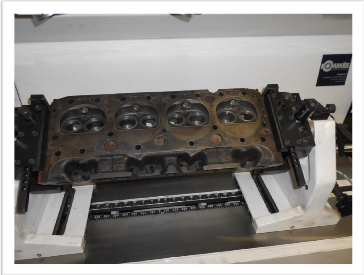
Figuur 27: plaatsen nieuwe klepzittingen
